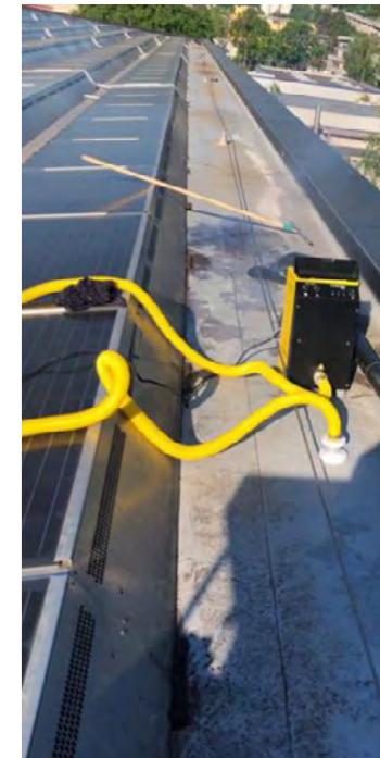
Für das Aufspüren von Leckagen und die Kontrolle der Dichtheit von Flachdächern kommt ein Rauchgenerator (auch Rauchmaschine genannt) zum Einsatz.
